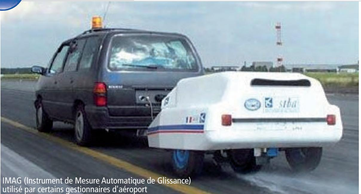
IMAG (Instrument de Mesure Automatique de Glissance) utilisé par certains gestionnaires d'aéroport
